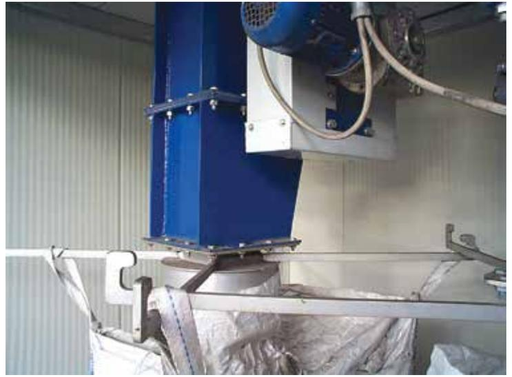
Le valvole a doppio clapet VDC sono ideali per controllare lo scarico di materiali in polvere o granulari. Particolarmente adatte per applicazioni pesanti e di depolverazione in tutti i settori industriali. Sono state progettate per lavorare con alte temperature, materiali altamente abrasivi e/o con grossa granulometria. Sono adatte per sistemi che non richiedono flusso continuo di materiale.
