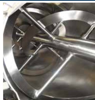
Polissage interne en acier inoxydable 304L / 316L
